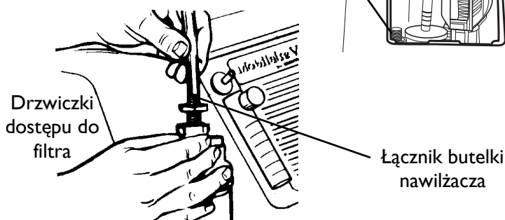
RYSUNEK 5.3 Podłączanie łącznika butelki nawilzacza
